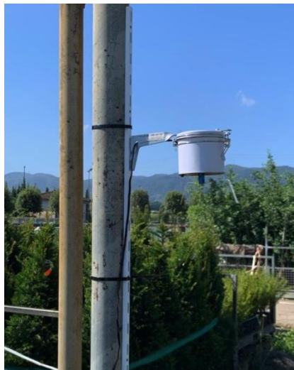
Figura 2 - Trappola captaspore posizionata in vivaio per intercettare spore e propaguli di inoculo di patogeni vegetali.
