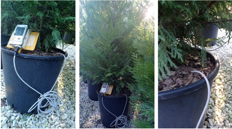
Figura 1 - Esempio di posizionamento di sensori di rilevamento della temperatura del substrato nelle prove sperimentali relative al controllo dei nematodi.
