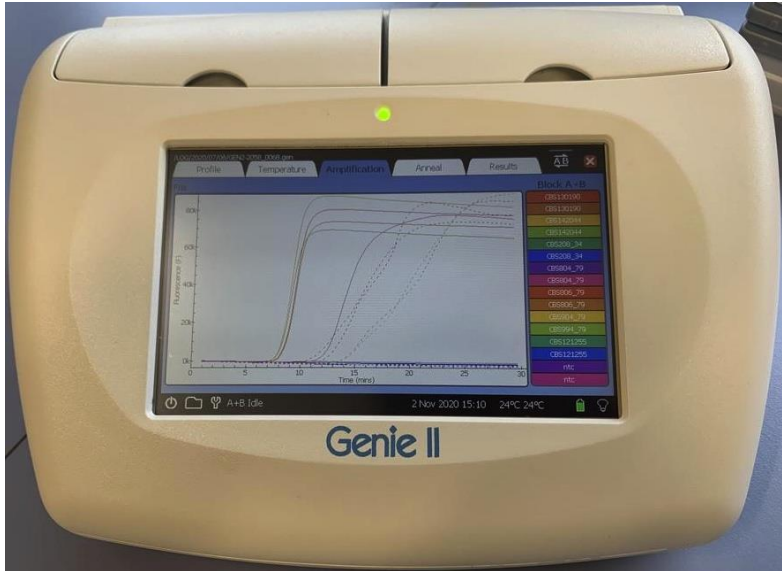
Figura 1 - Strumento portatile che utilizza la tecnica LAMP per rilevare patogeni direttamente in campo.
