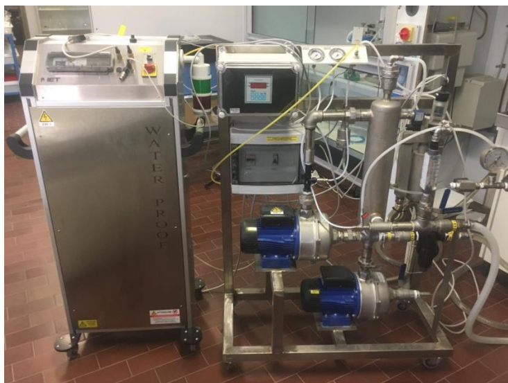
Fig.2 – Generatore di ozono modello WATER PROOF e sistema di ricircolo e arricchimento dell'acqua con l'ozono modello MOW (MET Srl, Bologna)
