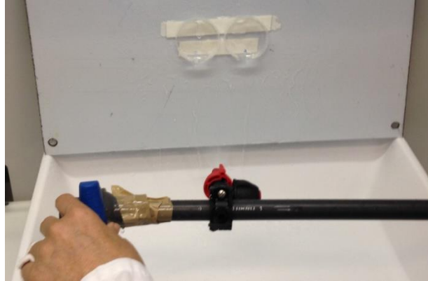
Fig. 3 – Nebulizzazione tramite lancia a bassa pressione su biofilm cresciuti su piastre da 55 mm di diametro
