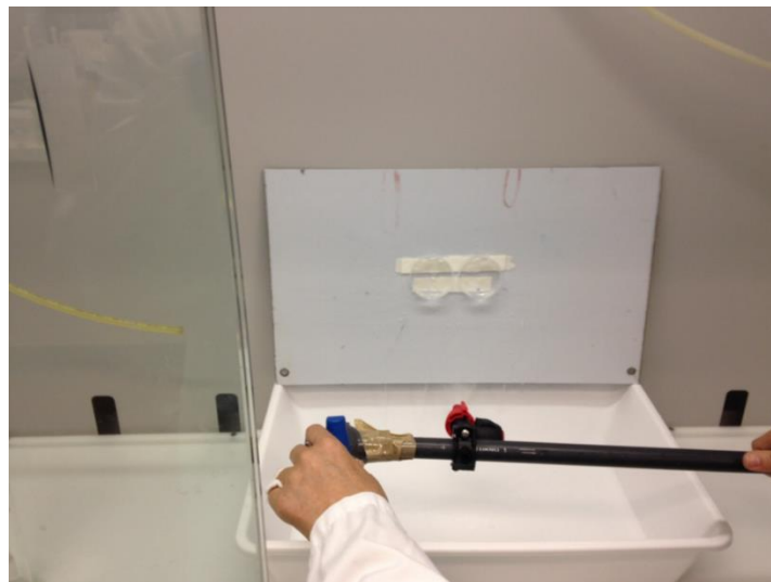
Fig. 11 - Trattamento con Ozono, “spraizzato” con lancia a bassa pressione, di biofilm in piastre da 55 mm
