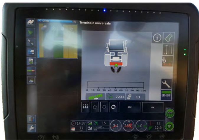
Sistema di posizionamento GPS su trattore
