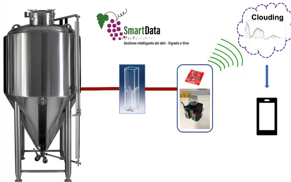
Figura 2 Schema di funzionamento del prototipo smart data
